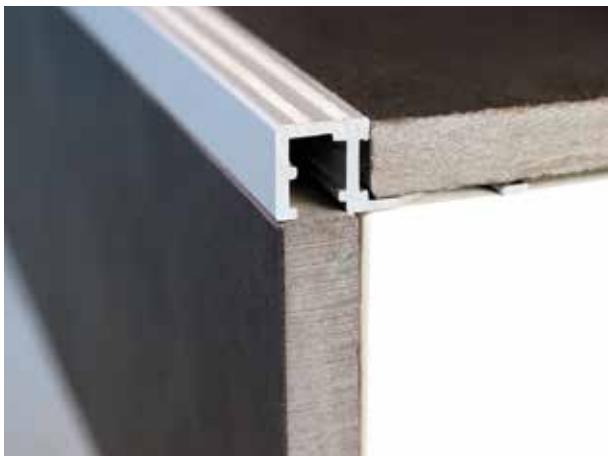
Squarejolly SJR con Resin Grip de sección cuadrada para el acabado y la protección del borde de las baldosas de los peldaños contra golpes e impactos mecánicos. Diseño minimalista y moderno, ideal para aplicaciones en el ámbito doméstico. Los trazos de resina en la superficie le dan al perfil la propiedad antideslizante, certificada R11. También son productos resistentes a la abrasión (PEI 3) y a los ataques químicos.
